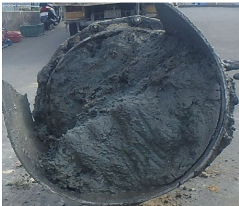
使用中止 (モルタル充填) DIP φ500 L=0.1m
