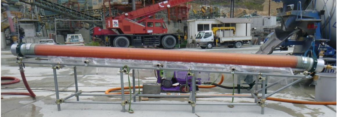
充填管模型 \phi 250 L=5.00m 水を満たした透明管(赤色着色)
